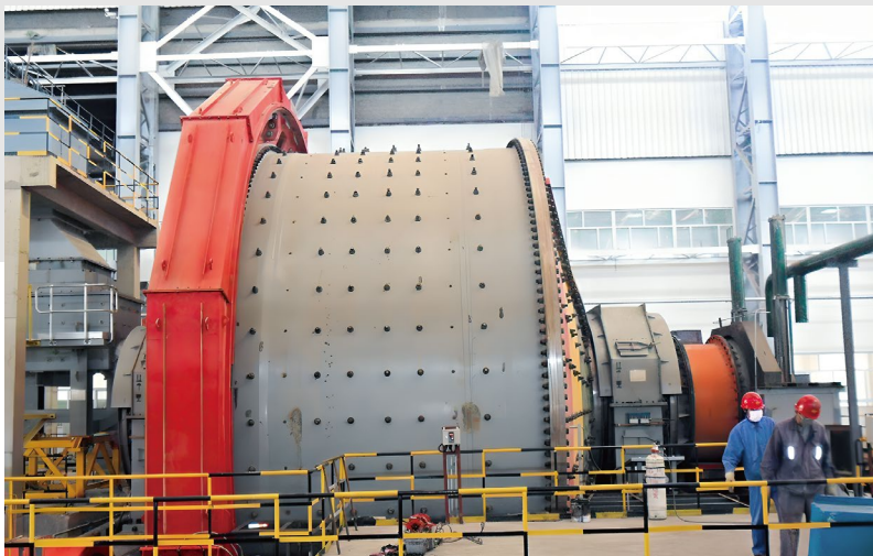
中国黄金集团满洲里乌山铜钼矿亚洲最大的半自磨机 (Φ11mX5.4m)
